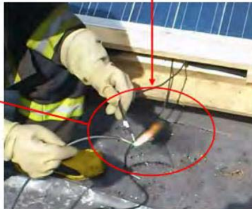
Lunghezza di fiamma di un arco elettrico in continua su impianto da 6kw – il colore della fiamma ne indica l'elevata temperatura
