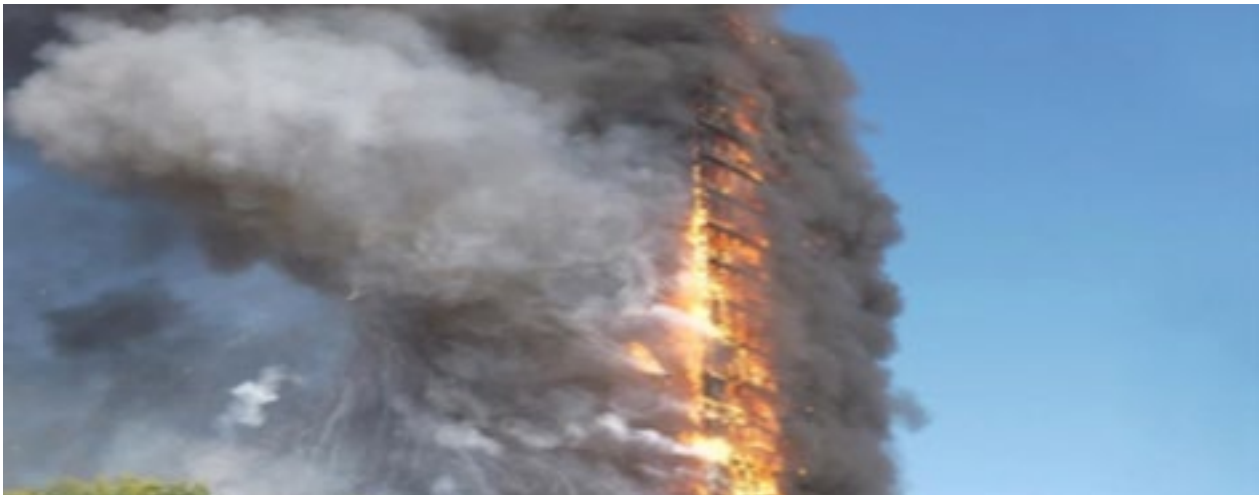
DIFFUSIONE DELL'INCENDIO SULLA SUPERFICIE ESTERNA DELLA PARETE
