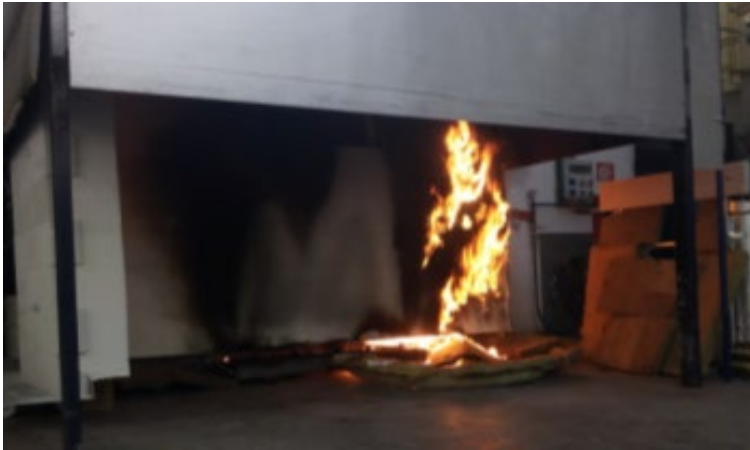
TEST - SISTEMI ETICS CON ISOLANTI CON ISOLANTI COMBUSTIBILI IN EPS
